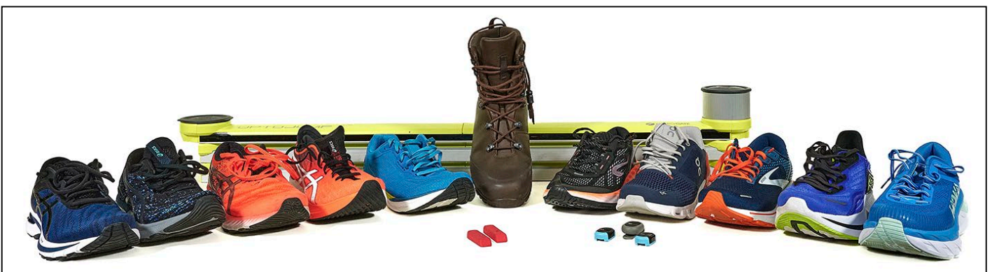
Afb. 3: De tien paar hardloopschoenen en de Haix laarzen die zijn vergeleken in deze casestudy. Op de voorgrond de sensoren van Sensorun (rood) en Runscribe (blauw). Op de achtergrond het optische meetsysteem Optojump (gele balken). Foto: LaFoot, Hilversum.
