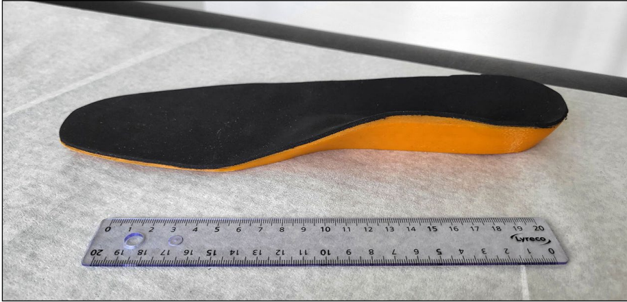
Afb. 1: Voorbeeld van een 3D-geprinte zool, zoals gebruikt in de huidige studie.
